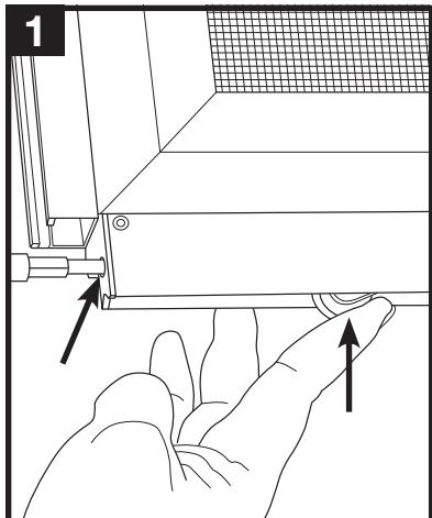
Usando la broca de seguridad a prueba de manipulaciones T25 Torx (**O**), ajuste las ruedas inferiores para que estén completamente retraídas.
