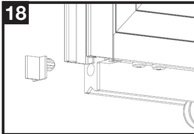
A continuación, inserte el extremo redondo del tapón del orificio (P) en el orificio del tornillo de ajuste en el lado del pestillo de la puerta.
