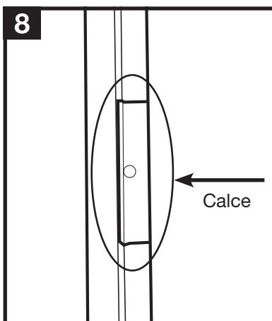
Si la puerta de su patio principal está equipada con un bolsillo que es más profundo que la pata de montaje del extensor de la jamba del pestillo, coloque las calzas (**G**) provistas en 5 lugares en la parte posterior de la pata de **montaje del extensor de la jamba (C)**. Puede ser necesario unir varias cuñas para despejar el borde del bolsillo e instalarlas planas en la parte inferior del bolsillo.
