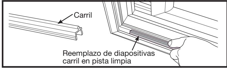
Su nueva puerta mosquitera de seguridad para patio siempre funcionará mejor cuando se instale y mantenga en un riel limpio de puerta mosquitera para patio. Limpie la pista a fondo con agua y jabón alrededor de la abertura. Seque completamente al aire o con una toalla antes de continuar con la instalación.
