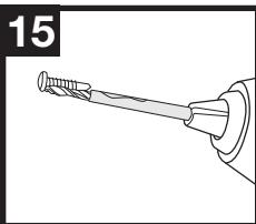
Marque una broca de 1/8 "con cinta adhesiva para indicar la longitud del tornillo de montaje de enclavamiento autopercorante # 6-20 x 5/8" (**I**). Perforar demasiado profundamente en la puerta del patio puede resultar en vidrios rotos o rotos.
