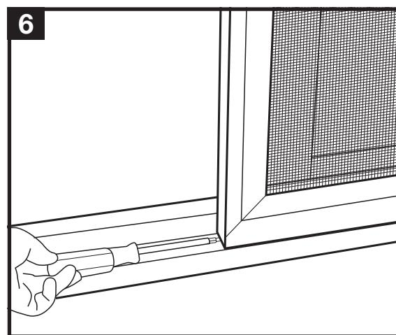
Usando la broca de seguridad a prueba de manipulaciones T25 Torx (**O**), ajuste las ruedas inferiores para levantar el panel más adentro del bolsillo superior de la puerta del patio y para una operación de deslizamiento suave según sea necesario.
