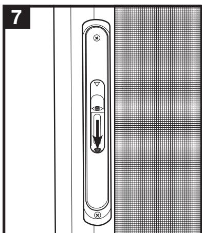
Asegúrese de que la cerradura multipunto esté desbloqueada presionando el pestillo en el interior del panel de la puerta con mosquitero de seguridad.
