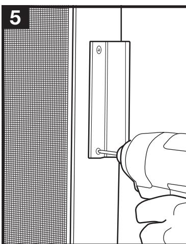
Instale la manija exterior (**B**) en el panel de la puerta mosquitera de seguridad (**A**) usando los tornillos (**K**) provistos.
