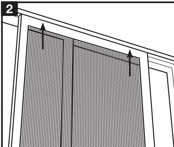
Coloque las ruedas superiores del panel (**A**) en el bolsillo superior de la puerta mosquitera, luego levante el panel y coloque las ruedas inferiores en su lugar en el riel de la puerta mosquitera.
