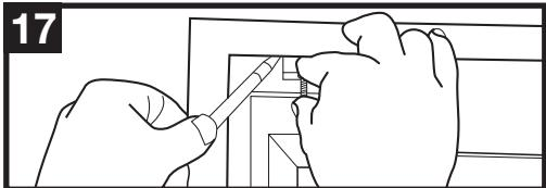
márquelos. Con una broca de 1/8", taladre el orificio de montaje e instale el tope deslizante con el tope mirando hacia el panel de la puerta con malla de seguridad para patio usando el tornillo de montaje de cabeza plana n.º 8 x 1-1/2" (L) provisto.
