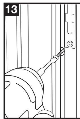
Marque y perfore orificios para montar el extensor de la jamba del pestillo (**C**) con una broca de 1/8". Sujete el extensor de la jamba del pestillo al marco de la puerta del patio usando los tornillos de cabeza troncocónica # 6 x 2-1 / 2" (**J**) provistos.
