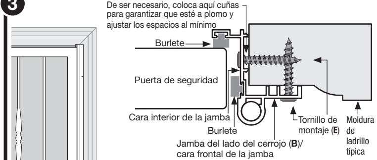
Con la puerta abierta, ajusta la jamba del lado del cerrojo (B) en la moldura de la puerta de entrada, a lo largo del borde del lado del cerrojo. Es importante que la parte superior de esta jamba esté nivelada con la parte superior de la jamba del lado de la bisagra, y que esté a plomo. Una vez en posición, usando uno de los tornillos de montaje (E) provistos, asegura la jamba a la moldura.
