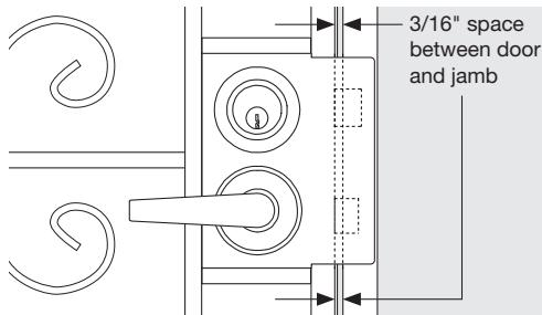
Alinea los orificios de los pernos del cerrojo en la jamba del lado del cerrojo con los pernos del cerrojo extendidos, dejando un espacio aproximado de 3/16" entre la puerta y la jamba, desde la parte superior a la inferior. Asegúrate de que la jamba esté verticalmente recta (aplomada).
