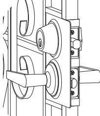
Fijar las cerraduras elegidas con un retiro de 2-3/8". (vendidas por separado) Extender completamente los pasadores del cerrojo a la posición de "cerrado".
