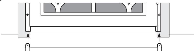
Colocar la barra inferior (**D**) debajo de las jambas laterales. Ambos extremos deben llegar hasta el borde exterior de las jambas laterales. Mantener en el lugar y perforar los orificios para los tornillos de montaje con una broca de 5/32". Fijar la barra inferior a cada jamba lateral con los tornillos (**H**) provistos.
