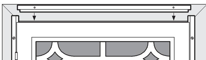
Colocar la jamba del travesaño superior (C) sobre la puerta y entre las dos jambas laterales. El espacio debe ser igual, de izquierda a derecha, sobre la puerta y ser similar al espacio determinado en el Paso 3. Marcar la ubicación de los orificios de montaje. Poner las jambas a un lado y donde esté marcado perforar los orificios de 3/16". Volver a colocar la jamba en su lugar y fijar a la estructura utilizando los tornillos unidireccionales (G) provistos.
