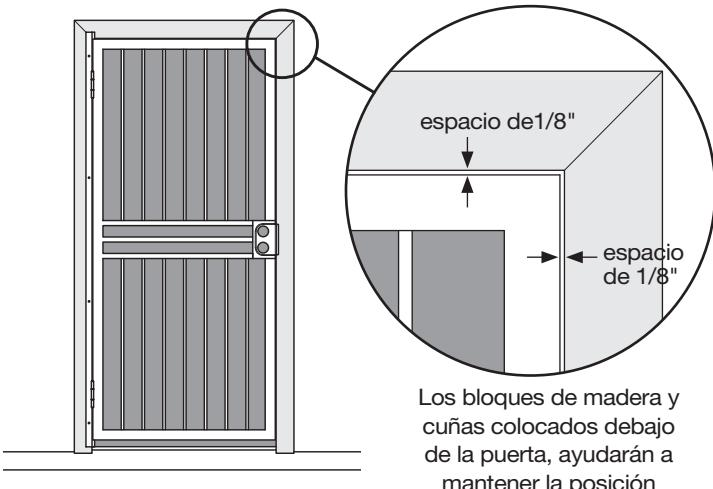
Poner el ensamblado de la jamba de la puerta/lado de la bisagra (A) frente a la abertura. Dejar un espacio de 1/8" entre el borde de la puerta, del lado de la cerradura, y el borde interior de tu superficie de montaje; además, debes dejar un espacio de 1/8" entre el borde superior de la puerta y el borde inferior de tu superficie de montaje (ver ilustración).
