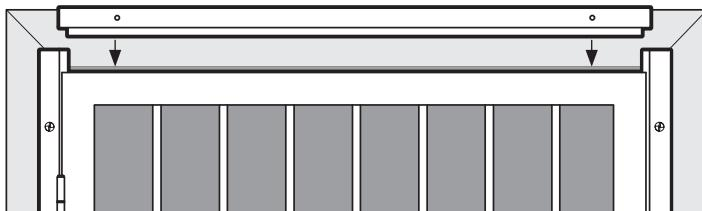
Colocar la jamba del travesaño superior (**C**) sobre la puerta y entre las dos jambas laterales. El espacio debe ser igual, de izquierda a derecha, sobre la puerta y ser similar al espacio determinado en el Paso 2. Marcar la ubicación de los orificios de montaje. Poner las jambas a un lado y donde esté marcado perforar los orificios de  $3/16"$ . Volver a colocar la jamba en su lugar y fijar a la estructura utilizando los tornillos unidireccionales (**G**) provistos.
