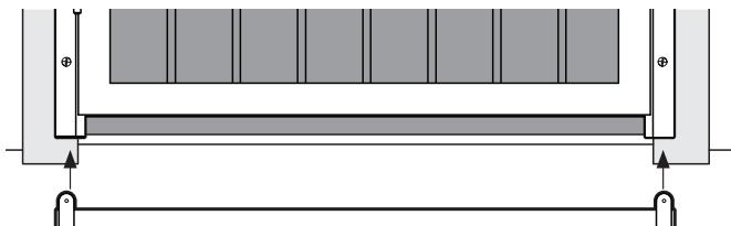
Colocar la barra inferior (**D**) debajo de las jambas laterales. Ambos extremos deben llegar hasta el borde exterior de las jambas laterales. Mantener en el lugar y perforar los orificios para los tornillos de montaje con una broca de  $5/32"$ . Fijar la barra inferior a cada jamba lateral con los tornillos (**H**) provistos.
